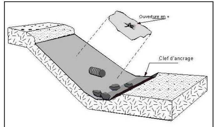
Figure 3 : Installation d'une membrane géotextile
