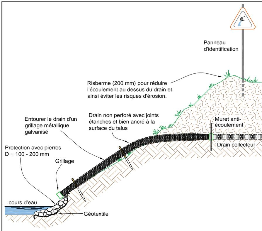
Figure 5 : Sortie de drain avec talus escarpé sans accès avec la machinerie
