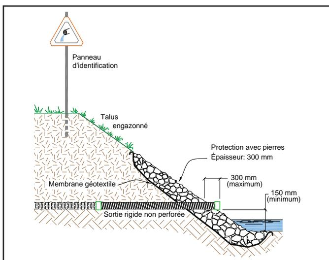
Figure 1 : Sortie de drain aménagée
