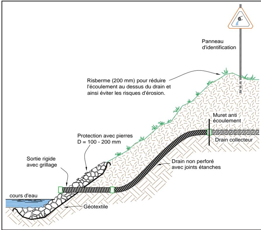
Figure 4 : Sortie de drain avec talus escarpé et avec accès pour la machinerie
